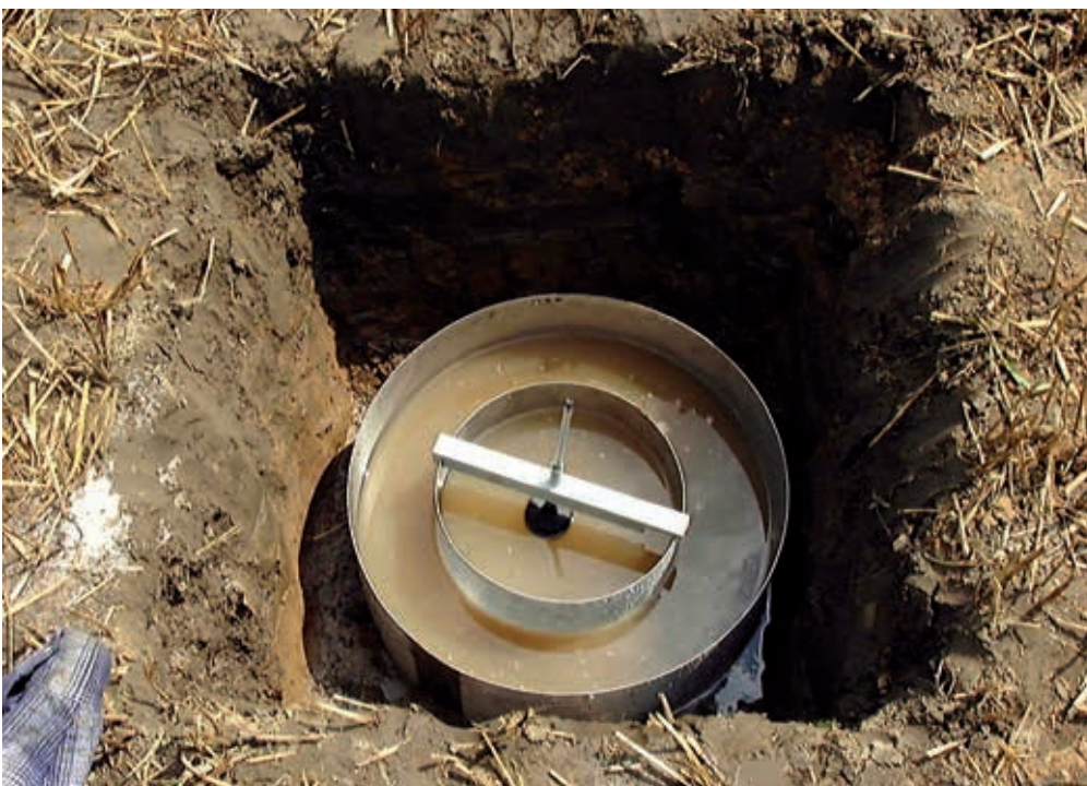
Doppelring-Infiltrationsmeter zur Bestimmung der Wasserdurchlässigkeit
