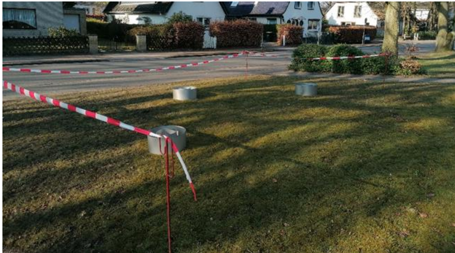
Abbildung 6 Abgesteckte Fläche für möglichen Muldenstandort und Verteilung der Infiltrometer
