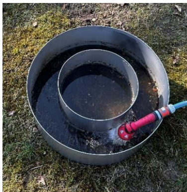
Abbildung 9 Befüllung zur Bodenvorsättigung
