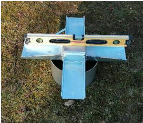
Abbildung 7 Innenring einschlagen und ausrichten
