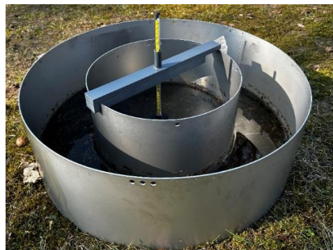
Abbildung 10 Infiltrometer mit Messbrücke und Schwimmer im Betrieb
