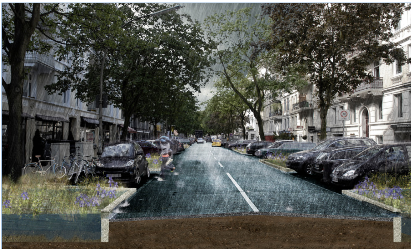
Abb. 48: Beispiellösung A - Entwässerung über Tiefbeete
