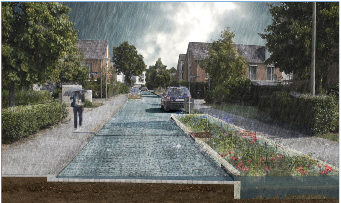
Abb. 69: Beispiellösung A - Entwässerung über Tiefbeete
