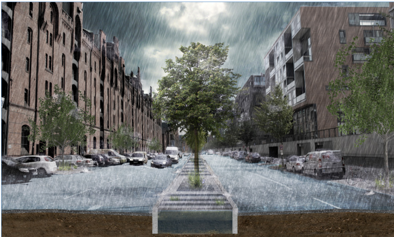
Abb. 43: Beipiellösung B - Entwässerung über speicherfähige Straßenbaumscheiben („treepits“)
