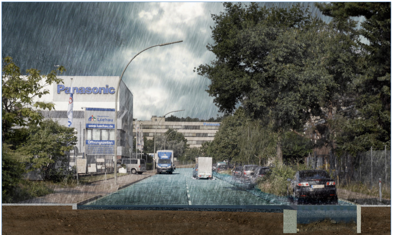
Abb. 55: Beispiellösung A - Entwässerung über Stellplatzstreifen in Tieflage
