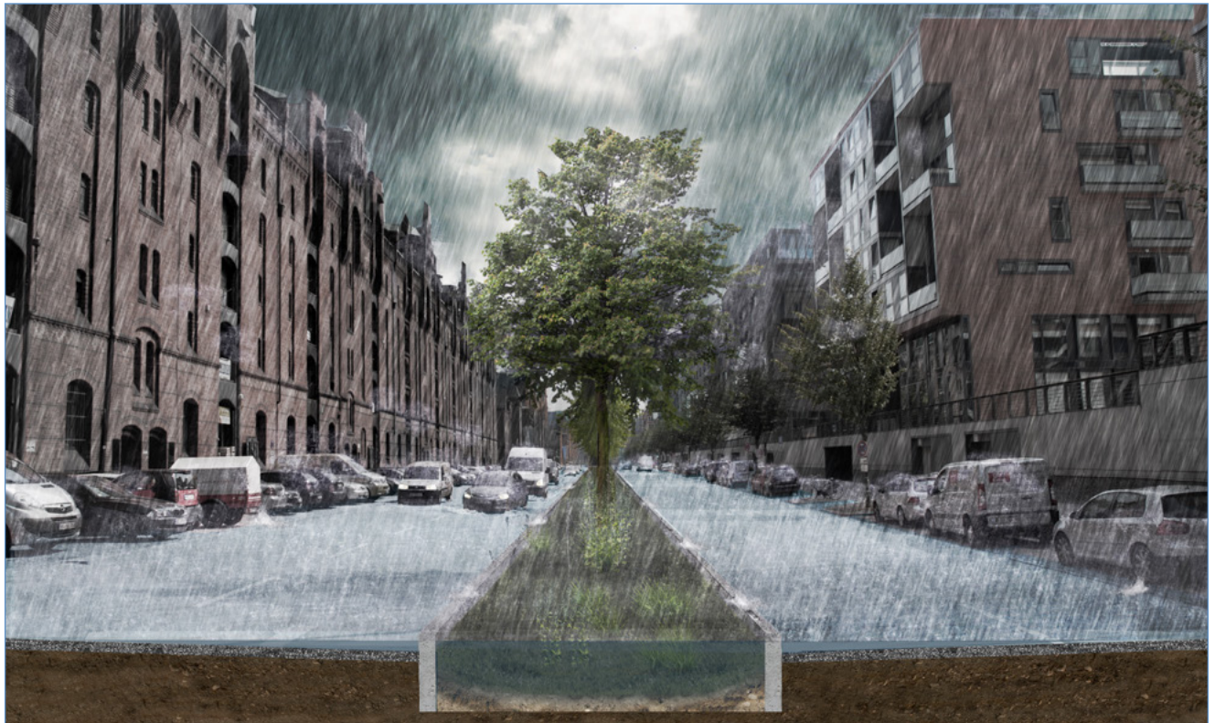
Abb. 41: Beispiellösung A - Entwässerung über Versickerungsmulde im Mittelstreifen
