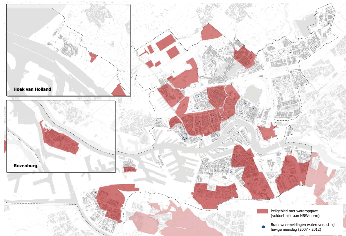
Abb. 2.21: Markierung der Kanaleinzugsgebiete, in denen zusätzliche Speicherkapazität für Niederschlagswasser zu schaffen ist (rote Gebiete) sowie Darstellung von Feuerwehreinsätzen bedingt durch Überflutungen (Zeitraum 2007-2012 - blaue Punkte), Stand 2013
