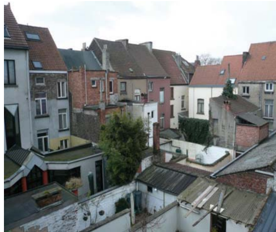
Abb. 1.10: Typische städtebauliche Situation in einem innerstädtischen Wohn- und Mischgebiet: hier erschweren der hohe Versiegelungsgrad, die kleinteiligen Grundstückszuschnitte, die heterogenen Eigentumsverhältnisse sowie die überwiegenden Satteldächer eine nachträgliche Umsetzung dezentraler Maßnahmen zur Regenwasserbewirtschaftung auf den privaten Grundstücken.
