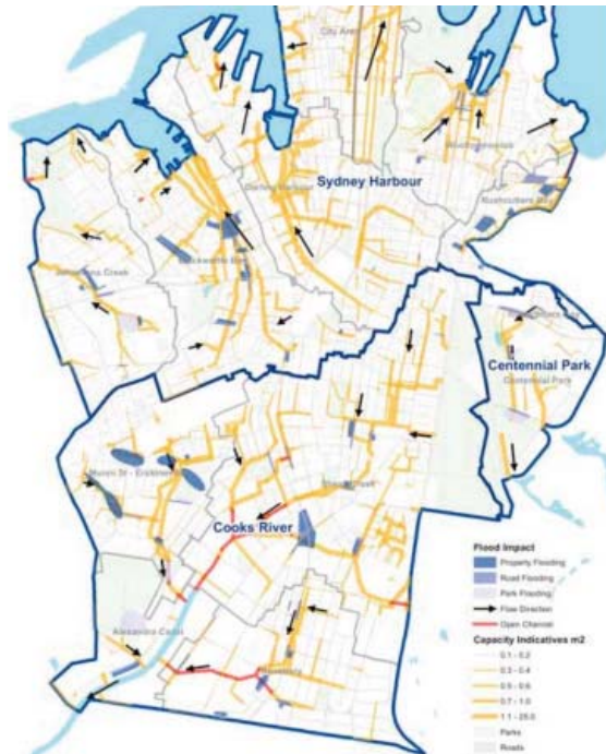
Abb. 5.16: Das Kanalsystem überlagert mit Überflutungs-Hot Spots
