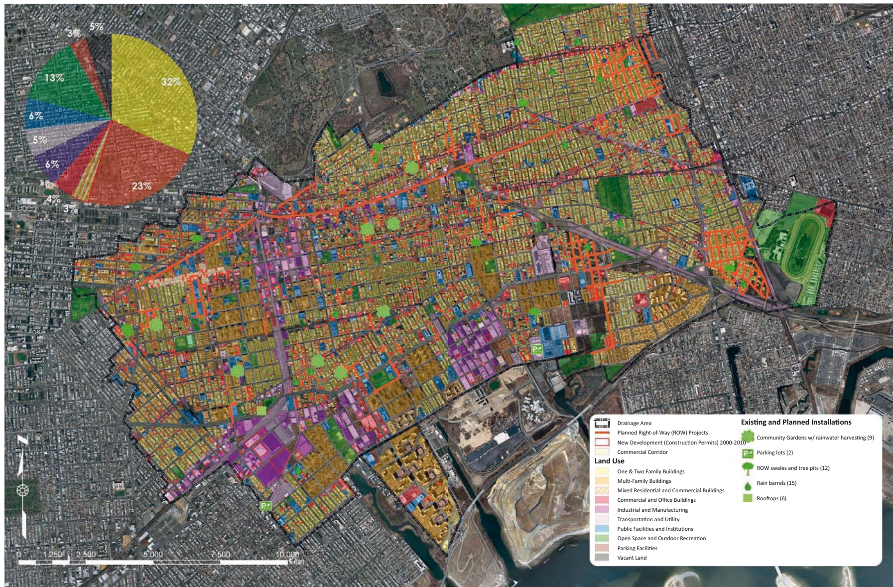
Abb. 2.10b: Darstellung der Verteilung der vorherrschenden Stadtstrukturtypen innerhalb des Einzugsgebietes und potentieller Standorte für grüne Infrastrukturmaßnahmen zur Versickerung des Niederschlagswassers. Zwölf Standorte für den Bau von Green Streets bzw. die Pflanzung neuer Straßenbäume wurden identifiziert.
