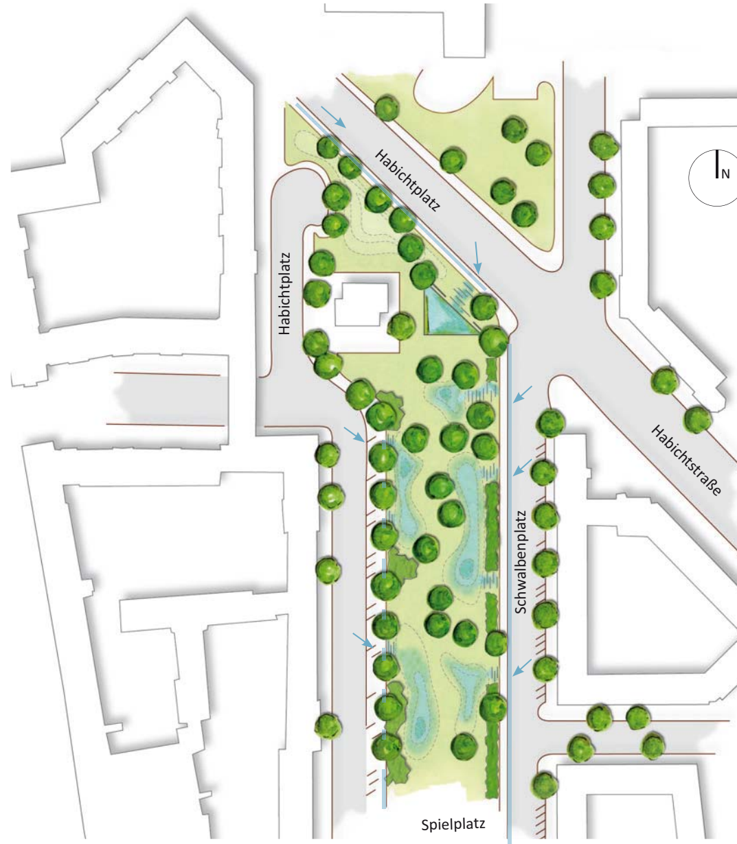
Abb. 3.48: Prüfung der Verortbarkeit von Versickerungsflächen innerhalb des Parks unter Berücksichtigung der Bestandsbäume (Darstellung unmaßstäblich)
