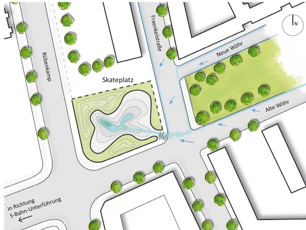
Abb. 3.72: Skizzenhafte Überlegungen zum Entwässerungskonzept (unmaßstäblich). Aufgrund der notwendigen Tieferlegung des Platzes können voraussichtlich keine Bestandsbäume erhalten werden. Inwieweit Neupflanzungen möglich sind, ist im Rahmen eines späteren Entwurfs zu klären.
