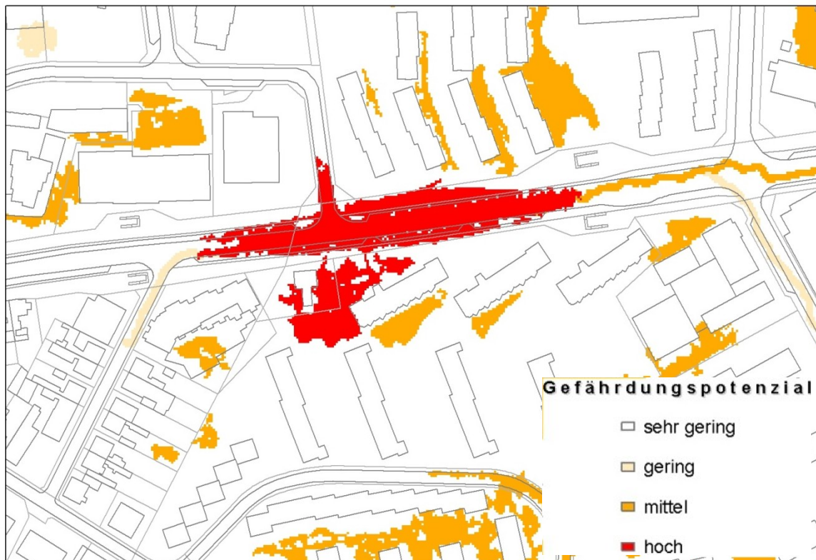
Abbildung 5.22: GPM-Karte, vier Gefährdungspotentialstufen am Beispiel der Möllner Landstraße in Hamburg, Quelle: HW
